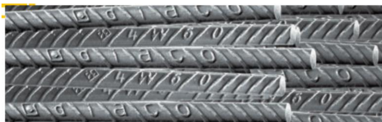
Figura 3 - 4. Acero de refuerzo. Fuente: (Diaco, 2015)
